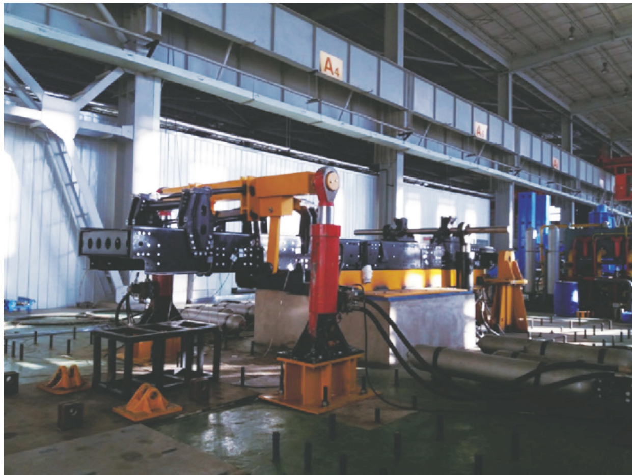
车架疲劳试验
